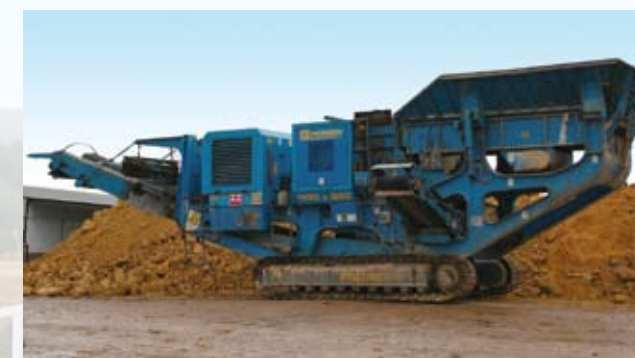
MACHACADORA MÓVIL. Tritura los residuos de construcción y demolición. A la salida dispone de un imán que separa el hierro del resto de materiales.
